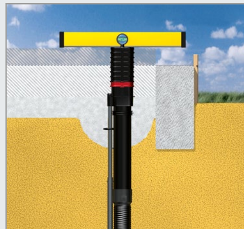
Abb. 12: Ausrichtung Quadro-Sicura® Basic-FUBO-E- R4+
